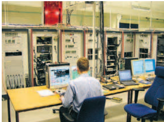
"Hardware-In-the-Loop"-simulatorens för integrations- och systemtestning av komplett fordon på Scania.
